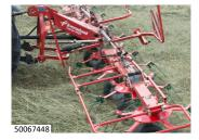
**KVERNELAND 8480** TEDDER, 8.05M WIDTH, 8 ROTOR
