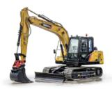
**SANY SY135C 15T CRAWLER EXCAVATOR** 700MM STEEL TRACKS
